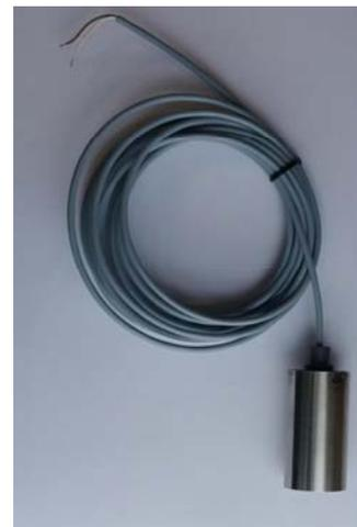
*Boya de nivel FARELL. Emplea un flotador interior provisto de imán y opera por contacto magnético. Cuerpo de acero inoxidable. Puede operar abriendo o cerrando el contacto, sin más que invertir el flotador interior. Verificar que abre el contacto cuando cubierta por el agua. Cable de 5 m.*
